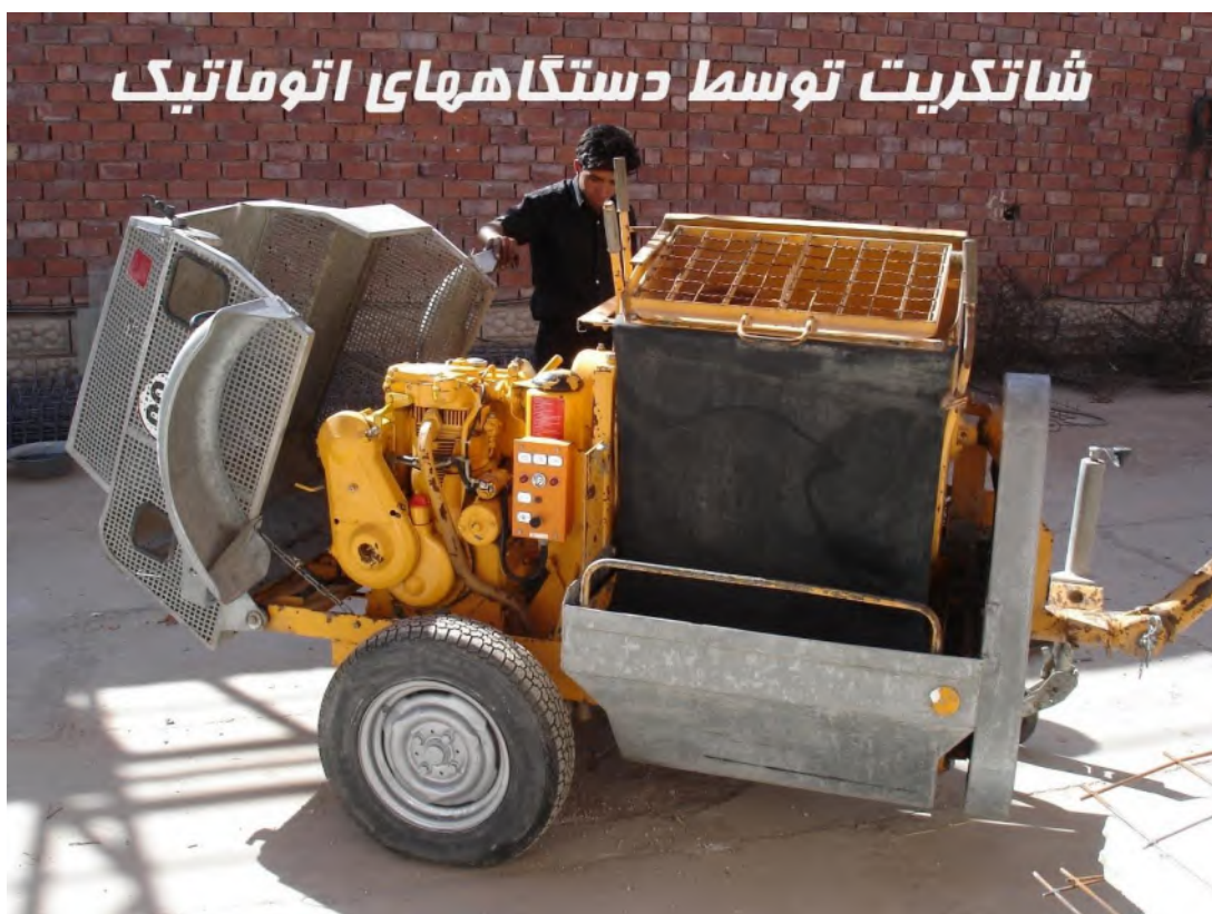
شکل (۶-۱۳): دستگاه تمام اتوماتیک اجرای شاتکریت
