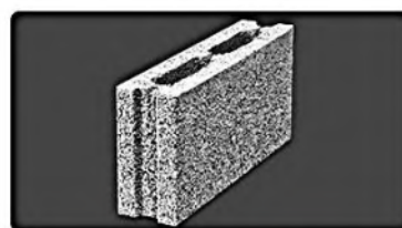
تیغه ای توخالی ته پر با دو سوراخ Size: 40x10x20 Max. Weight: 5.5 kg Sound Resistance: 45 db
