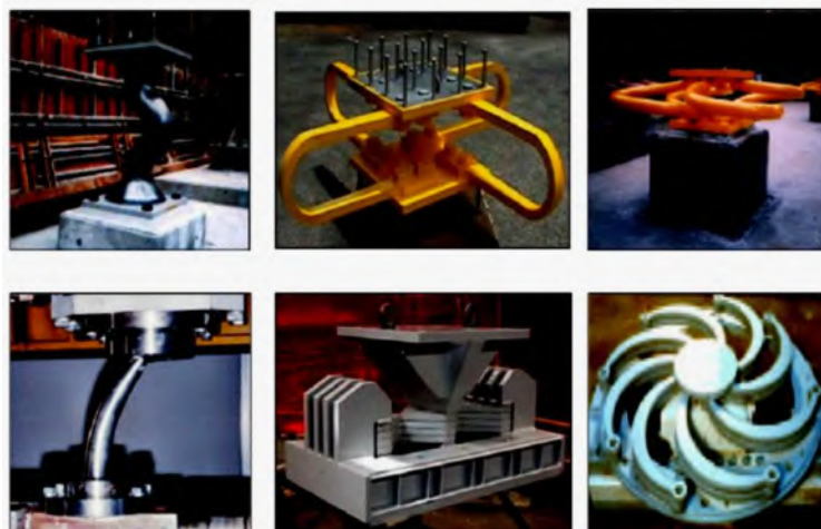
شکل (۹-۵): نمونه‌هایی از انواع میراگرهای تسلیم شونده فلزی
